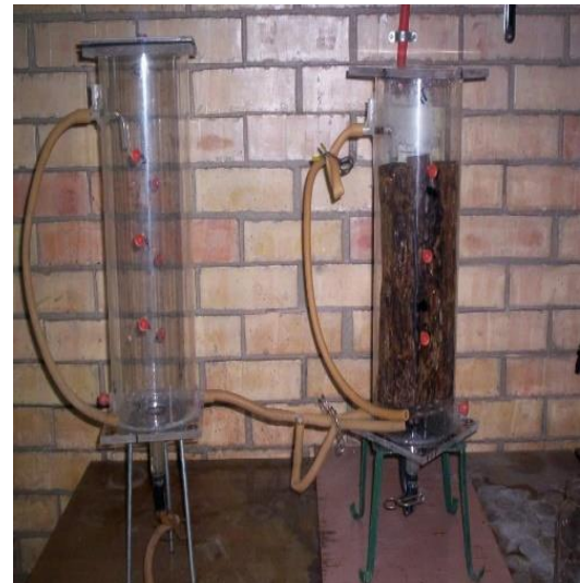
Figura 1. Reactor Empacado (lado derecho), y reactor con lodo granular anaerobio (lado izquierdo).
